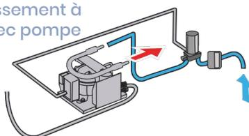
Refroidissement à l'eau avec échangeur de coque
